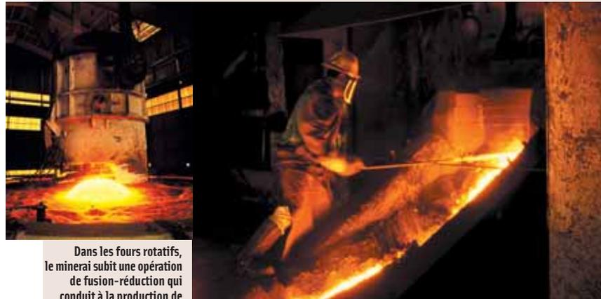
Dans les fours rotatifs, le minerai subit une opération de fusion-réduction qui conduit à la production de ferro-nickel.
